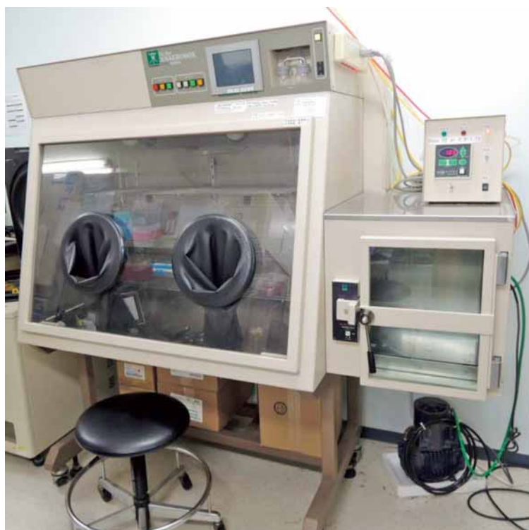
人工的に低酸素環境を作る装置。内側は酸素濃度1%に設定されており、エベレストの頂上より酸素濃度が低くなっている
